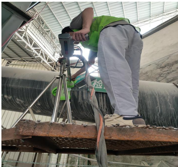
粉尘废气处理前采样
